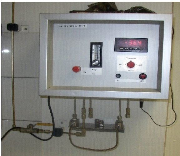
Prüfplatz zur Bestimmung der Rohrfeuchte
