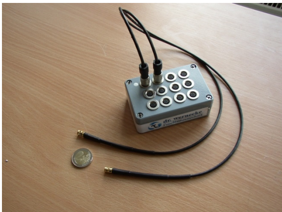
Messwertgeber mit Multikonverter für 12 Messfühler
